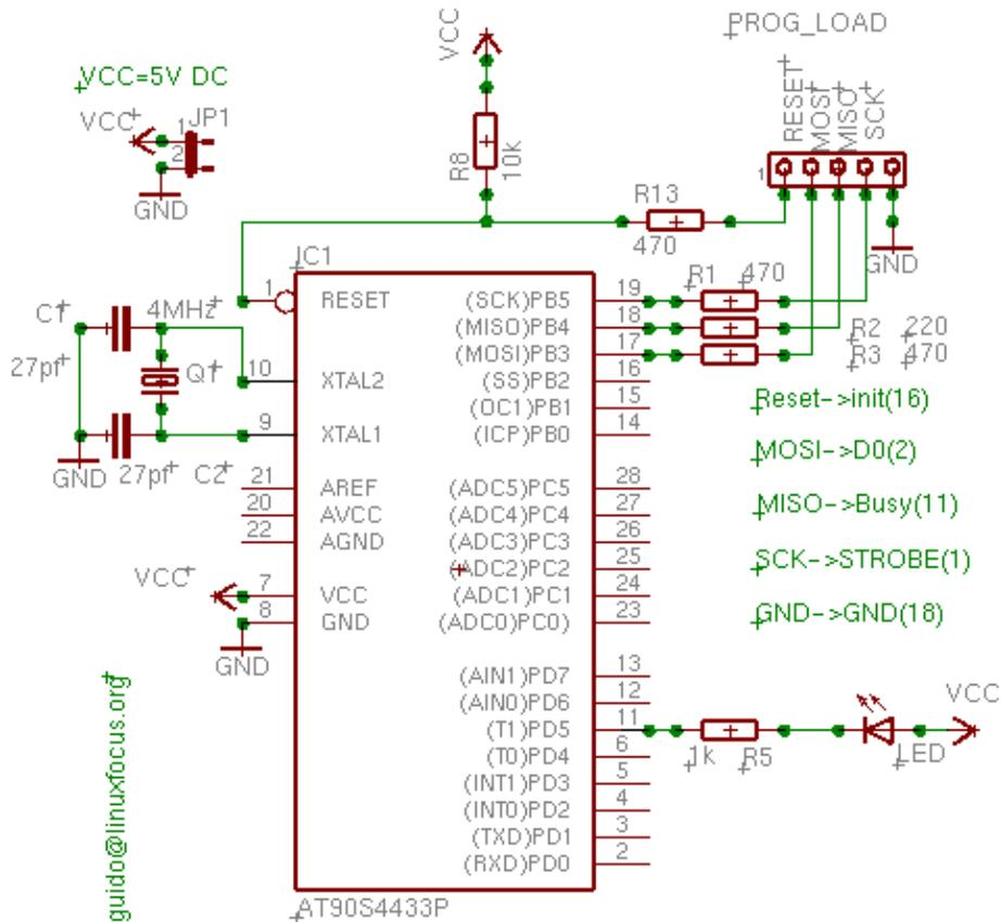
Les résistances sur le connecteur pour le programmeur ne sont pas réellement nécessaires dans notre cas. Vous n'en aurez besoin que si vous avez prévu d'utiliser les lignes d'entrées/sorties du port B pour d'autres raisons.
